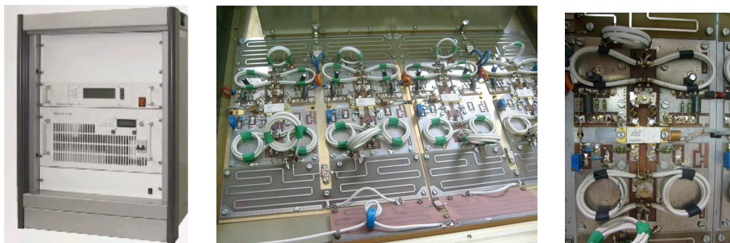
Slika 3.10. FM predajnik - slika iz kataloga i unutrašnjost jednog modula
