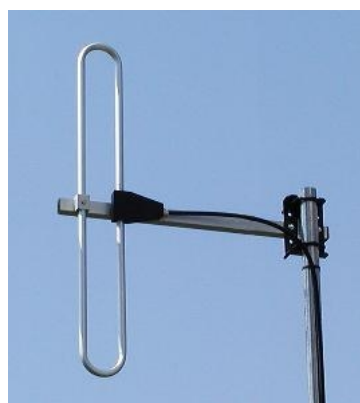
Slika 2.39. Modifikacije simetričnog dipola – bikonična antena i presavijeni dipol
