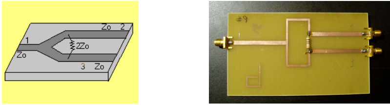
Slika 2.13. Wilkinson-ov delitelj snage – blok šema i fotografija
