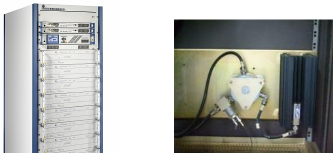
Slika 3.12. TV predajnik kompanije Rohde & Schwarz – slika iz kataloga i cirkulator u na izlazu poslednjeg pojačavačkog stepena
