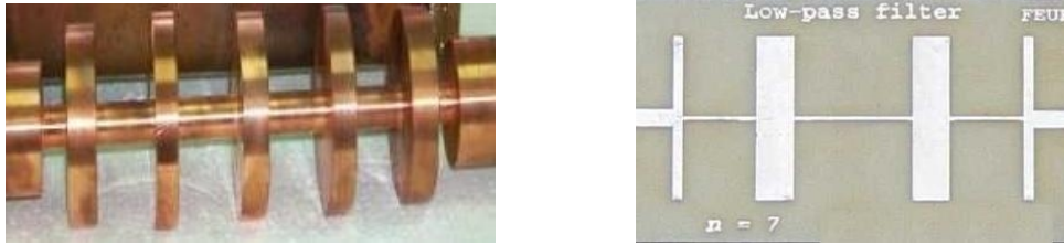
Slika 2.23. Stepped-impedance filter realizovan u tehnici koaksijalnih i mikrotrakastih vodova
