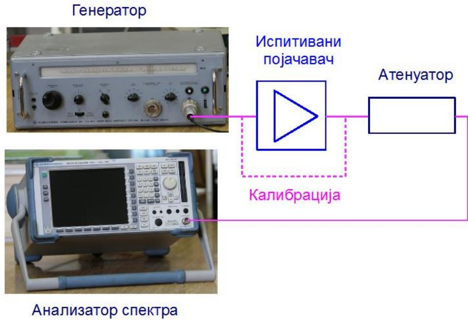
Слика 5.3.1.3. Мерење 1 dB compression point анализатором спектра.
