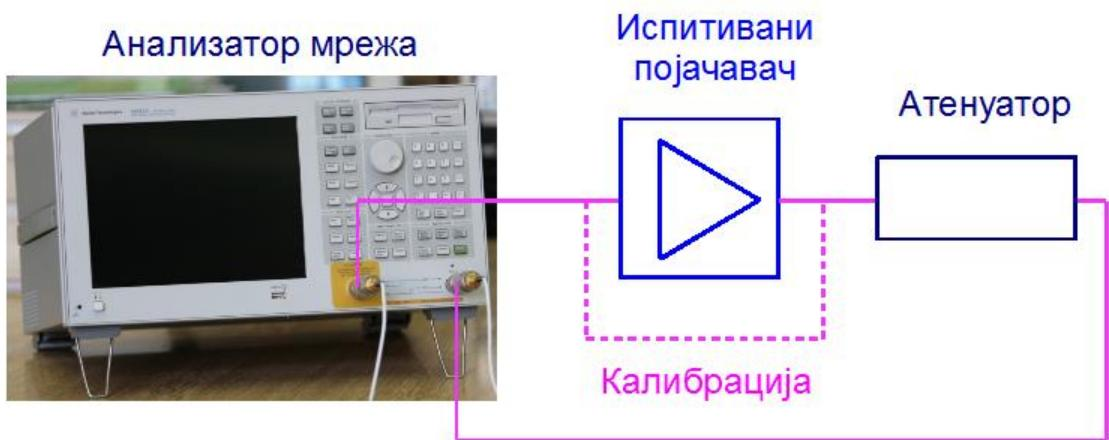
Слика 5.3.1.1. Мерење 1 dB compression point анализатором мрежа.
