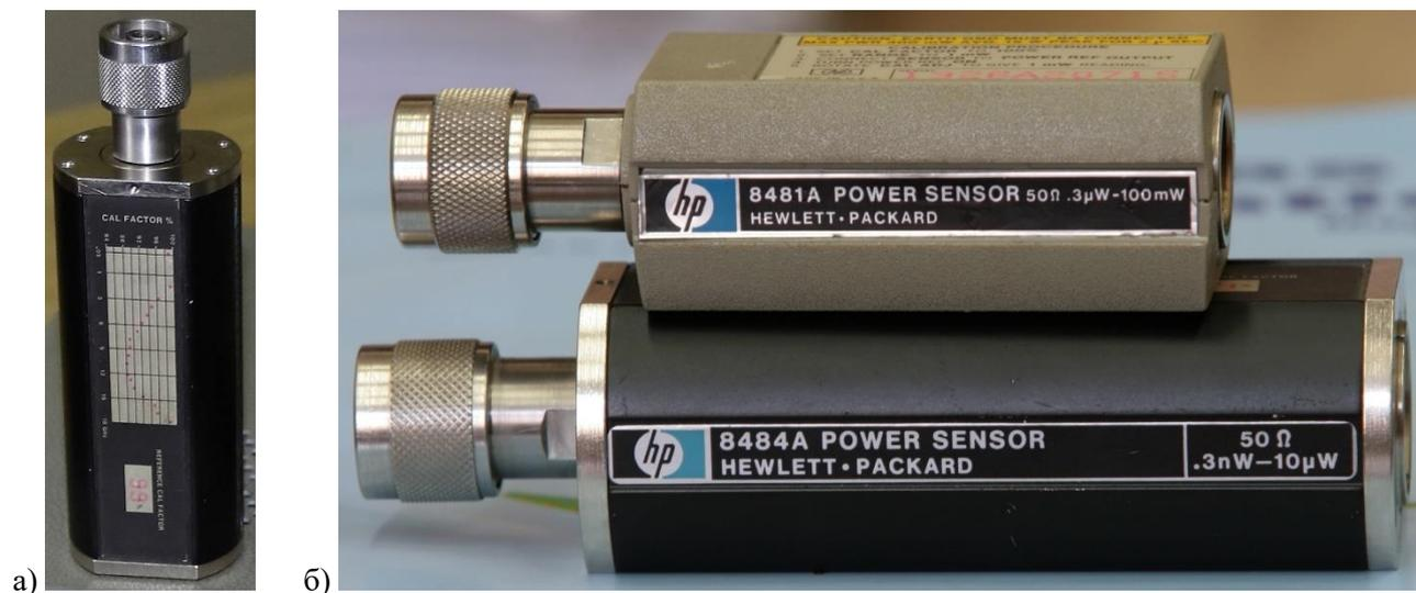
Слика 3.4.5. а) Диодни сензор снаге HP 8484A са назначеним калибрационим факторима и б) сензори снаге са термопаром HP 8481A и диодом HP 8484A са назначеним опсезима снаге.
