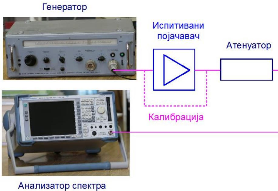
Слика 5.3.1.3. Мерење 1 dB compression point анализатором спектра.
