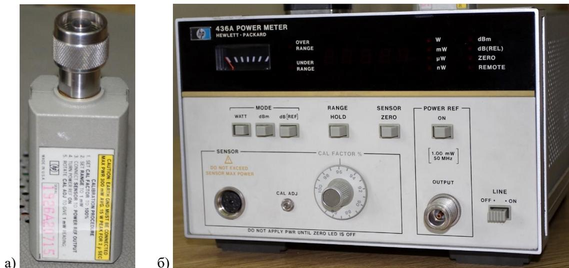
Слика 3.3.1. а) Сензор снаге са термопаром и б) одговарајући мерач снаге.
