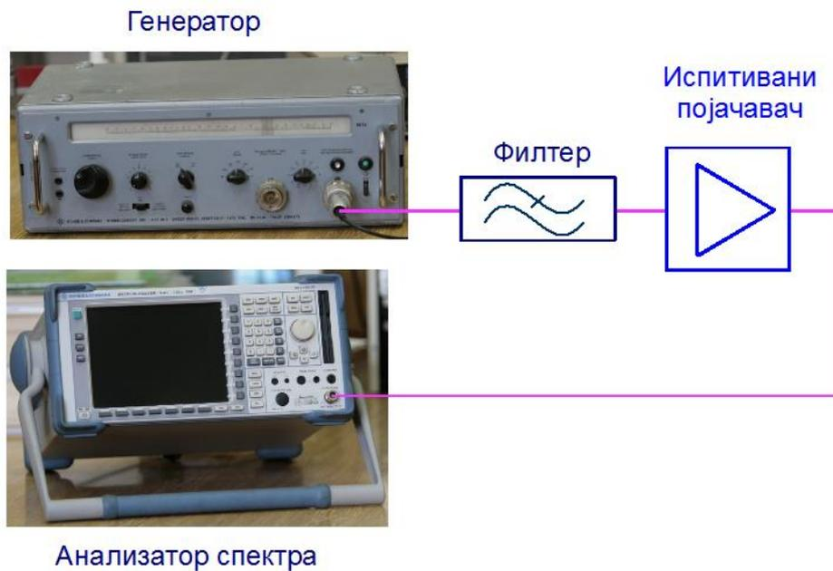
Слика 5.3.2.2. Мерење хармоника анализатором спектра.
