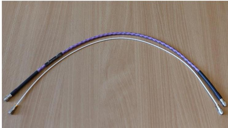
Слика 1.6.6. Два коаксијална кабла са фабрички уграђеним 1.85 mm конекторима.
