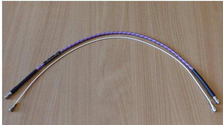
Слика 1.6.6. Два коаксијална кабла са фабрички уgraђеним 1.85 mm конекторима.
