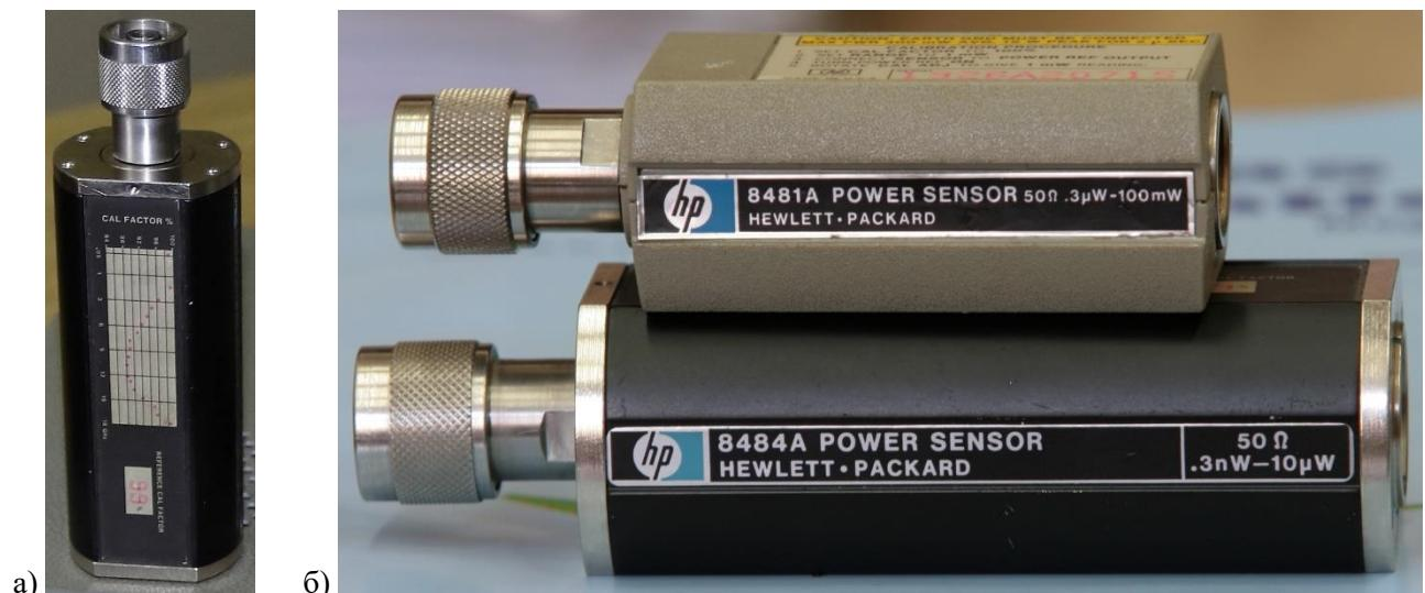
Слика 3.4.5. а) Диодни сензор снаге HP 8484A са назначеним калибрационим факторима и б) сензори снаге са термопаром HP 8481A и диодом HP 8484A са назначеним опсезима снаге.
