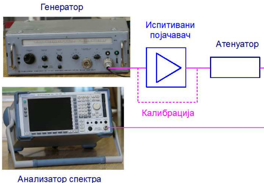
Слика 3. Мерење 1\text{ dB} compression point анализатором спектра
