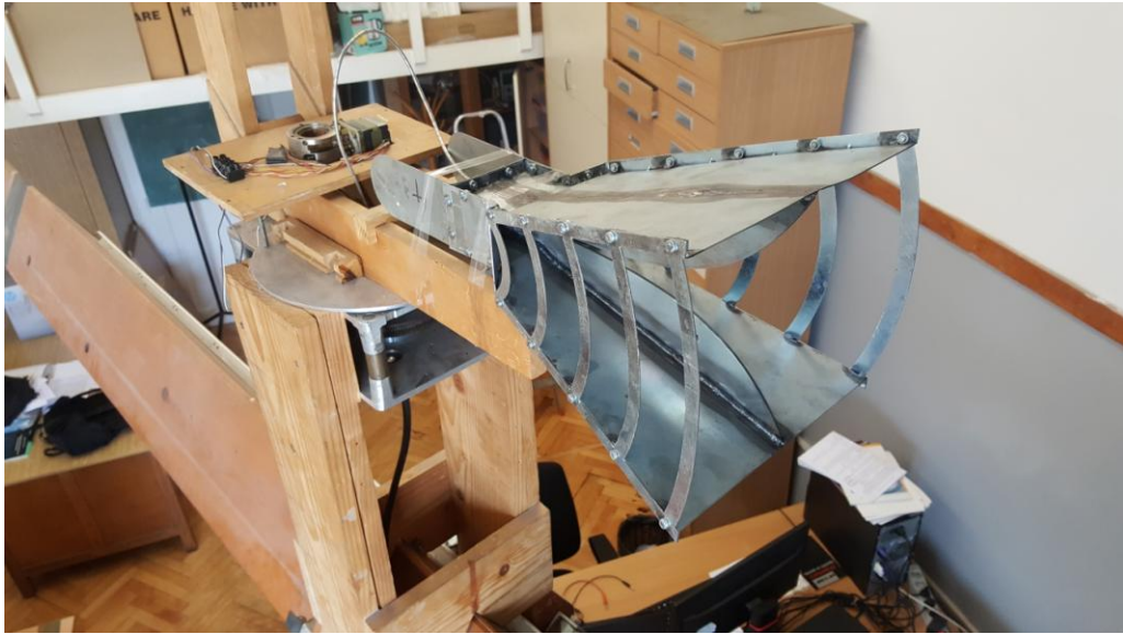
Слика 5.6. Предајна хорн антена коришћена у антенском мерењу.
