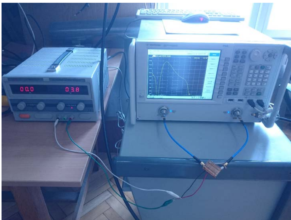
Слика 4.1 Комплетна мерна поставка и мерење коефицијента трансмисије појачавача.
