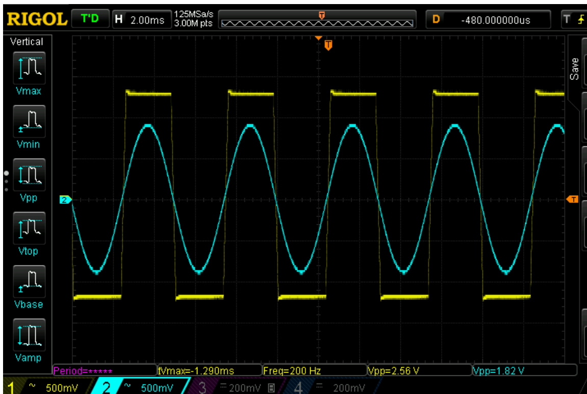
Слика 4.11. Временски облик напона на улазу (плаво) и на излазу (жуто) кола за аутоматску контролу појачања за учестаност сигнала 200 Hz, када је коло у дубоком засићењу.
