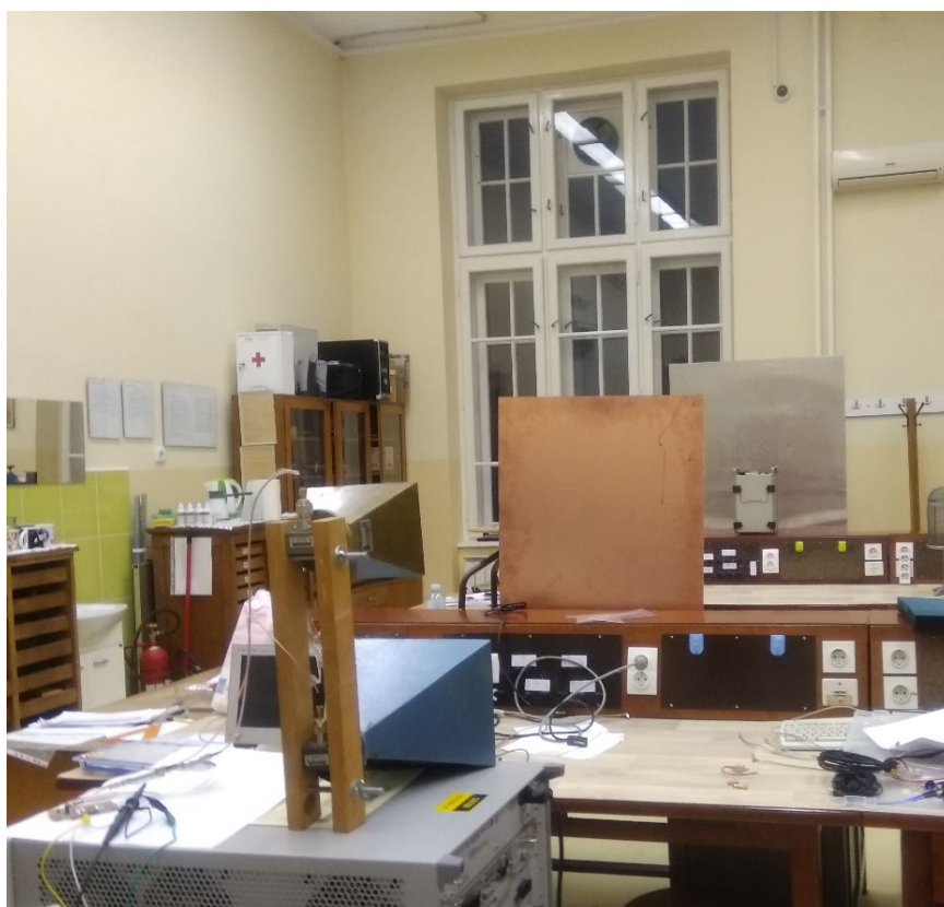
Слика 4.15. Приказ два објекта који се детектују (две плоче) испред антена радара.
