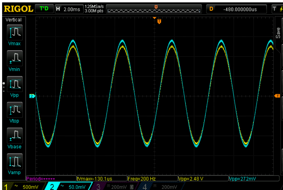
Слика 4.9. Временски облик напона на улазу (плаво) и на излазу (жуто) кола за аутоматску контролу појачања за учестаност сигнала 200 Hz, када је на улазу напон изнад границе стабилизације.
