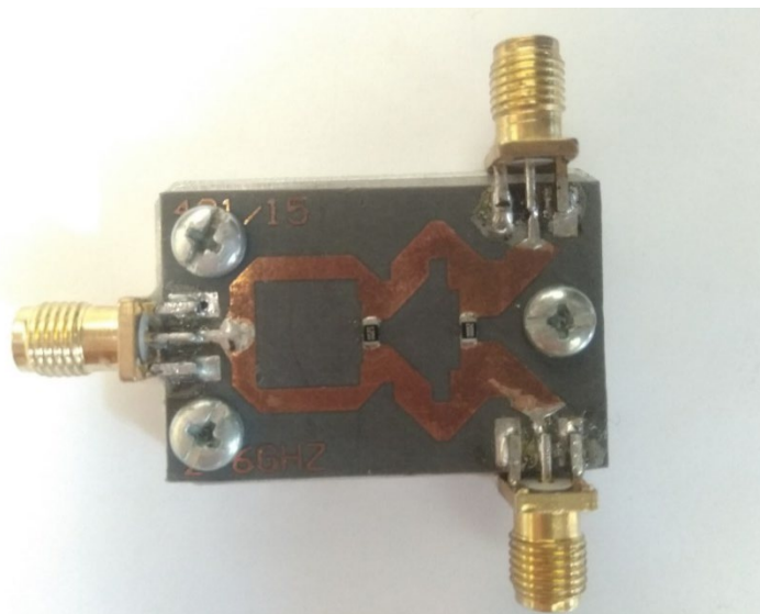
Слика 3.2. Изглед прототипа делитеља снаге.
