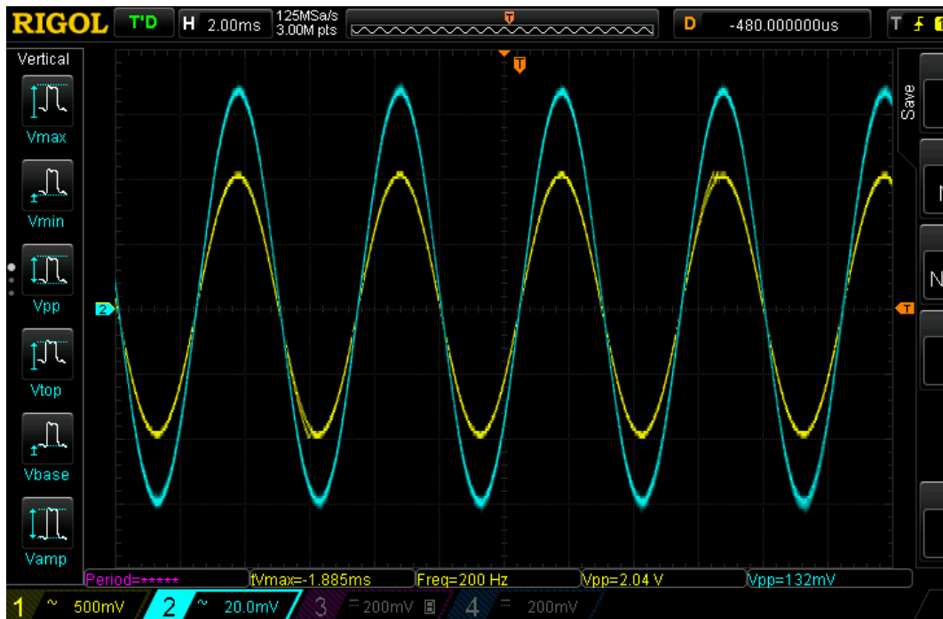
Слика 4.8. Временски облик напона на улазу (плаво) и на излазу (жуто) кола за аутоматску контролу појачања за учестаност сигнала 200 Hz.
