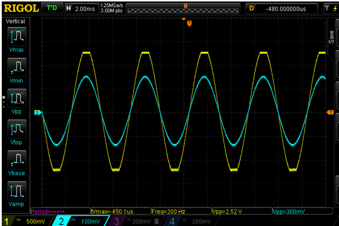
Слика 4.10. Временски облик напона на улазу (плаво) и на излазу (жуто) кола за аутоматску контролу појачања за учестаност сигнала 200 Hz, при уласку у засићење.
