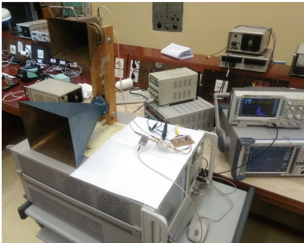
Слика 4.14. Мерна поставка за тестирање целокупног радарског система.
