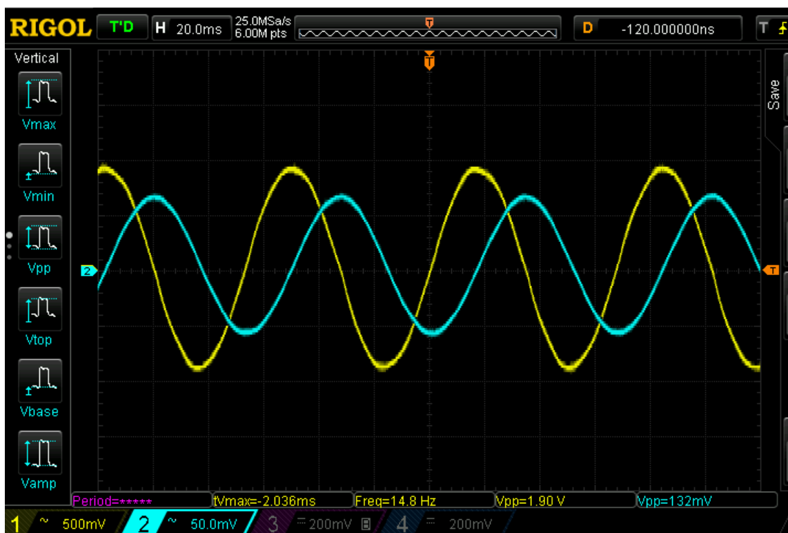
Слика 4.5. Временски облик напона на улазу (плаво) и на излазу (жуто) кола за аутоматску контролу појачања за учестаност сигнала испод учестаности у којима је задовољена функционалност кола (14,8 Hz).
