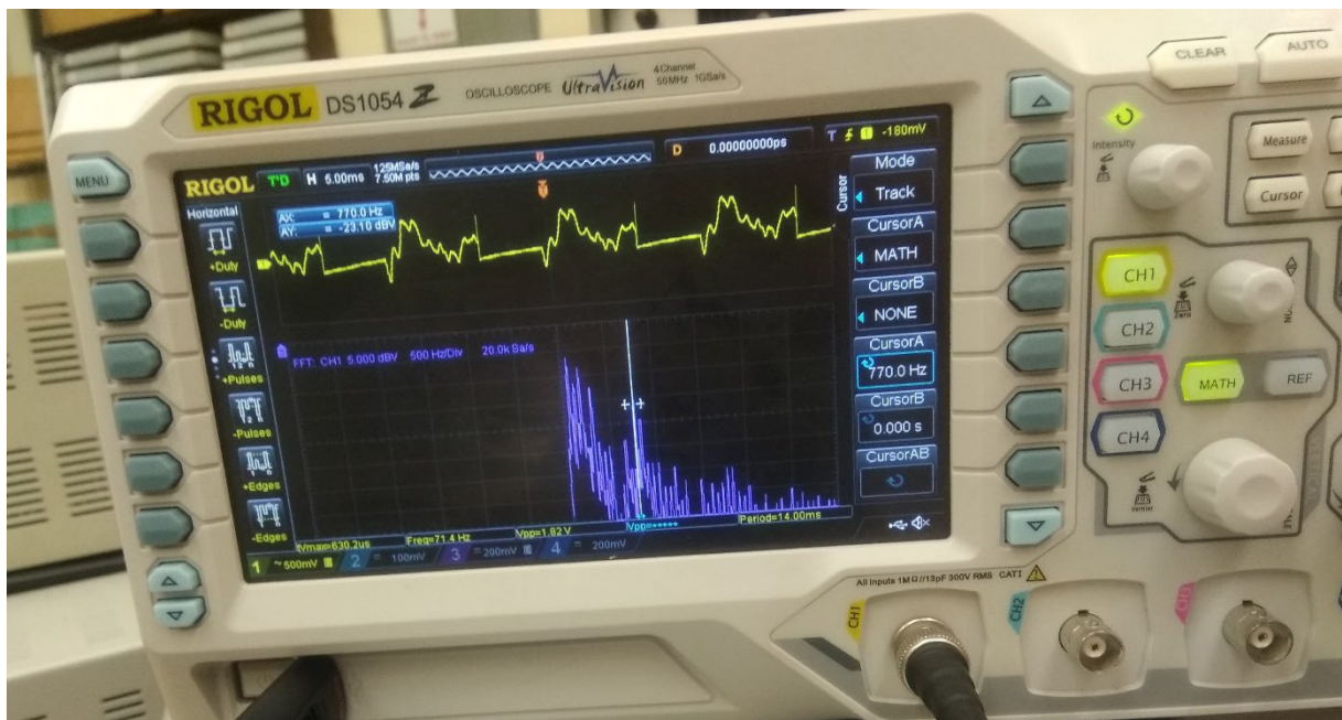
Слика 4.18. Приказ временског облика сигнала на излазу радара (жуто) и спектра тог сигнала (љубичасто), као последица присуства даље мете.
