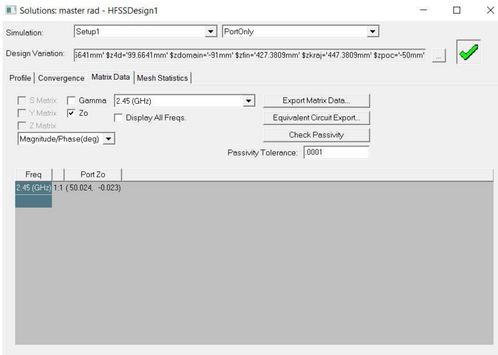
Слика 2.4.2.7. Карактеристична импеданса напојног коаксијалног вода на централној учестаности.
