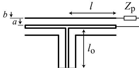
2. Na slici je prikazan mikrotrakasti vod dužine  $l = 22,1 \text{ mm}$ , širine  $w = 1,57 \text{ mm}$  i zanemarljive debljine metalizacije. Vod je napravljen na supstratu debljine  $h = 0,5 \text{ mm}$  i relativne permitivnosti  $\epsilon_r = 2,16$ . Izračunati s-parametre ovog voda na učestanosti  $f = 2,5 \text{ GHz}$ , ukoliko prvi pristup (port) čine početak voda i masa, a drugi pristup čine kraj voda i masa. Nominalne impedanse oba pristupa su  $Z_0 = 50 \Omega$ .
