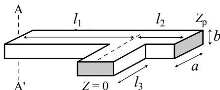
3. Na slici je prikazan mikrotrakasti vod dužine  $l = 22,1 \text{ mm}$ , širine  $w = 1,57 \text{ mm}$  i zanemarljive debljine metalizacije. Vod je napravljen na supstratu debljine  $h = 0,5 \text{ mm}$  i relativne permitivnosti  $\epsilon_r = 2,16$ . Izračunati s-parametre ovog voda na učestanosti  $f = 2,5 \text{ GHz}$ , ukoliko prvi pristup (port) čine početak voda i masa, a drugi pristup čine kraj voda i masa. Nominalne impedanse oba pristupa su  $Z_0 = 50 \Omega$ .
